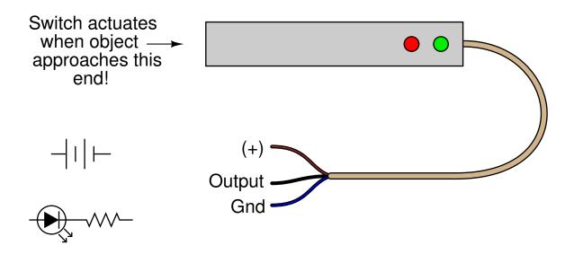
Vis hvordan du ville koblet kretsen nedenfor slik at LED-en lyser når sensoren aktiveres. Anta at utgangen er sourcing (PNP).
