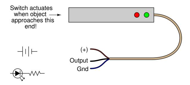
Vis hvordan du ville koblet kretsen nedenfor slik at LED-en lyser når sensoren aktiveres. Anta at utgangen er sinking (NPN).
