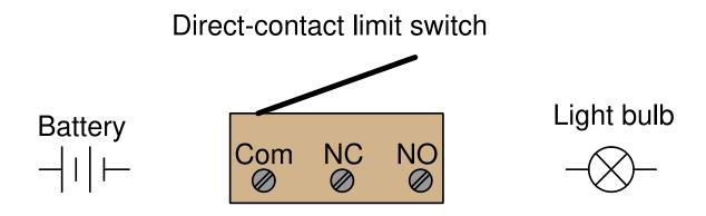
Vis hvordan du ville koblet kretsen ovenfor slik av endebryeren slukker lyset når den aktueres. Lyset skal altså normalt være på. file i02242
